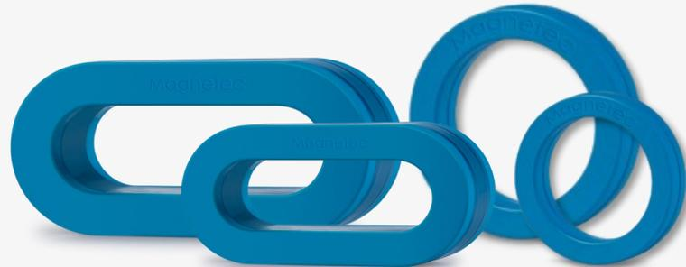
I nuclei CoolBlue® riducono le interferenze ad alta frequenza aumentando l'impedenza del sistema solo per le correnti ad alta frequenza, senza influire sul funzionamento del sistema. L'energia dell'interferenza viene convertita in calore mediante l'assorbimento del picco di corrente attraverso il nucleo nanocristallino.
