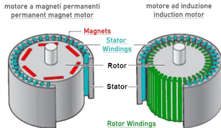
Alcune configurazioni particolari dei magneti sul rotore permettono, inoltre, di creare una riluttanza saliente nel circuito magnetico, la quale, se sfruttata, consente di generare coppia aggiuntiva (coppia di riluttanza) e regolare un motore sincrono (a riluttanza o ibrido) nella zona di deflussaggio.
